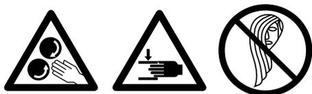
**Опасно!** Не касаться пространства между подвижными деталями, например, между **транспортировочными роликами (4)**. При работе с открытой системой не носить неплотно прилегающие предметы одежды, например, шарфы, платки, галстуки; длинные волосы следует заколоть или защитить головным убором.
